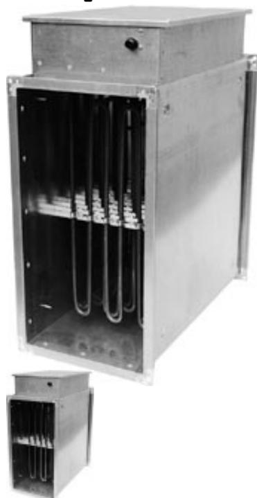
Канальные нагреватели РВЕР предназначены для подогрева воздуха в воздуховодах прямоугольного сечения. Корпус и коммутационная коробка изготовлены из оцинкованной стали, нагревательные элементы – из нержавеющей стали. Степень защиты: IP 40
