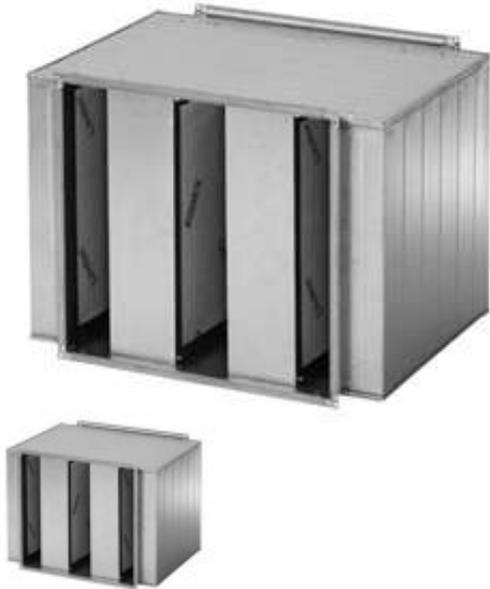
Шумоглушитель LDR-B оснащен встроенными шумопоглощающими пластинами, в том числе двумя внешними боковыми шумопоглощающими пластинами. Присоединительный размер остается неизменным. Шумоглушитель LDR-B в комбинации с двумя внешними шумопоглощающими пластинами уменьшают риск свободных колебаний, а так же существенно снижают шум, особенно на низких частотах. Специально разработанный изоляционный материал Lindtec имеет хорошие шумопоглощающие свойства, малый вес и легко чистится.
