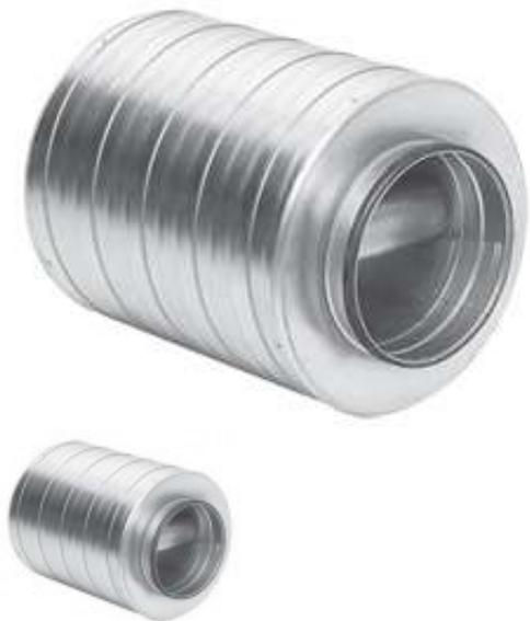
Шумоглушитель круглого сечения с мембраной. 100 мм мембрана дает очень хорошее поглощение шума на всех октавных полосах. Данный шумоглушитель используется, когда требуется большое снижение шума и шумоглушителя LDC недостаточно. Предназначен для больших сечений воздуховодов. Изоляция шумоглушителя 100 мм.
