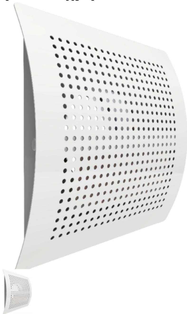
BOR-R разработан специально для подачи воздуха в жилые помещения, отели и офисы. Приток воздуха осуществляется без сквозняков, при минимально возможных шумах. Прежде чем попасть в рабочую зону приточный воздух достигает необходимого уровня температуры. Максимально допустимый перепад температур составляет  $\Delta T 10^{\circ}\text{C}$ . BOR-R оснащен устройством для регулирования расхода воздуха и измерения перепада давления.
