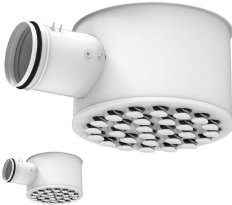
Универсальная регулировка воздушного потока; Благодаря отличным характеристикам смешения приточного воздуха с воздухом в помещении даже при небольших объемах, такие диффузоры хорошо использовать для VAV-вентиляции; Высокая производительность наряду с низким уровнем шума и умеренными перепадами давления; Компактная конструкция с клапаном и измерительными зондами (на приток и на вытяжку)
