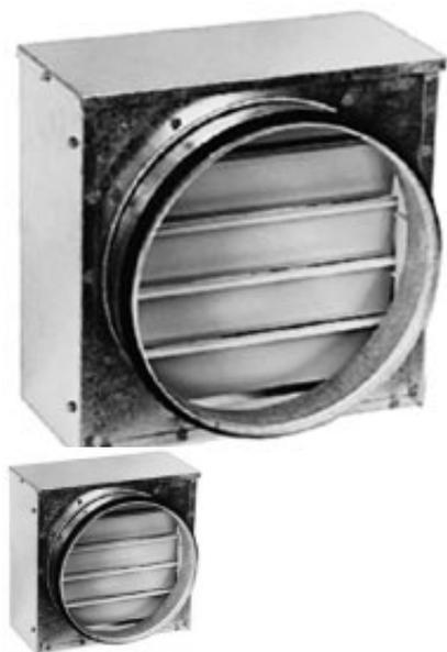
Обратный клапан КВО предназначен для автоматического перекрывания воздуховодов в системах приточной и вытяжной вентиляции при выключении вентиляторов.
