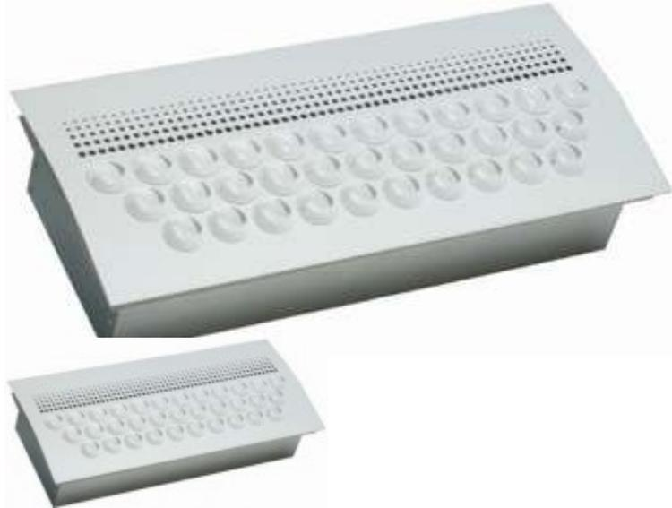
Sinus-B - настенный диффузор, в котором функциональность (высокая пропускная способность) сочетается с привлекательным внешним видом. Диффузор идеально подходит для подачи охлажденного воздуха и обеспечивает высокую интенсивность эжекции при низкой дальности струи. Подсоединение к диффузору Sinus-B осуществляется сзади (для Sinus-BR) или сбоку (для Sinus-BS).
