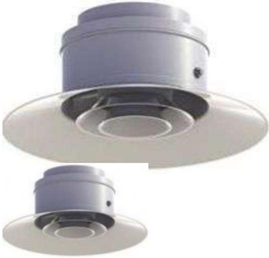
Изделие серии ДКП - это корпус с патрубком, с расположенной внутри центральной вставкой, которая представлена, как набор цилиндров, имеющих конический раструб. Модель такого типа участвует в формировании комбинированного поступающего потока: симметричной веерной струи через щелевое устройство между корпусом и диффузором внутри и вертикальной конической струи, идущей через вставку в центре - все это гарантирует равномерные параметры воздушного потока в рабочей части помещения.
