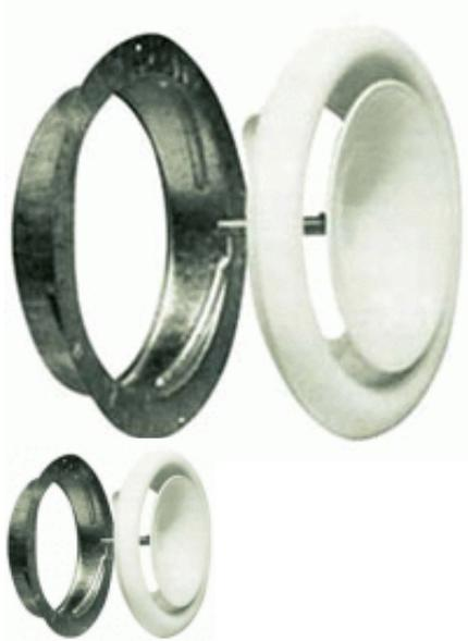
Диффузоры VS...М предназначены для применения в приточных системах вентиляции и кондиционирования. Они представляют собой потолочные воздухораспределительные элементы с плавным регулированием расхода воздуха, которое осуществляется с помощью вращения центрального диска. Диффузоры изготавливаются из стали и имеют защитное порошковое покрытие белого цвета. Для удобства монтажа диффузоры снабжены соединительной муфтой, с помощью которой они присоединяются к воздуховодам.
