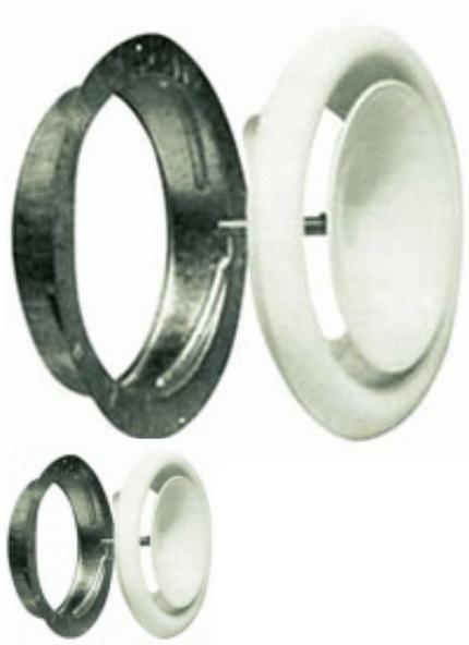
Устройство серии VE – это корпус, патрубок для монтажных работ и дисковый обтекатель подвижного типа. Соединение изделия с воздухопроводом производится посредством патрубка. Вращающийся обтекатель движется вдоль оси симметрии диффузора, таким образом, меняя «живое сечение» для перемещения воздушной массы и аэродинамические характеристики устройства, благодаря чему происходит равномерный выход воздуха через диффузор.
