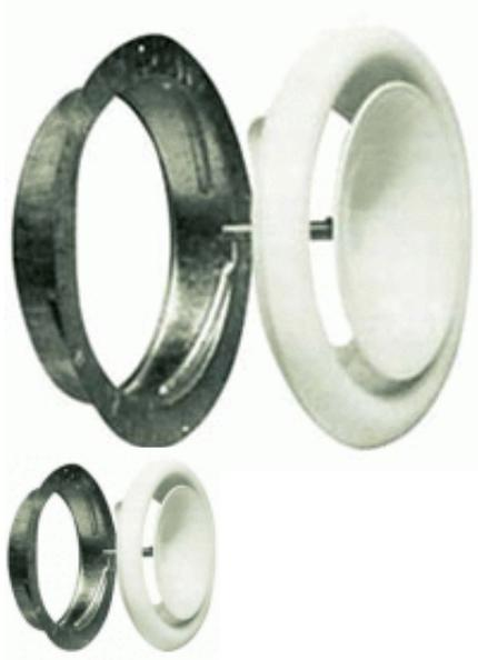
Устройство серии VE – это корпус, патрубок для монтажных работ и дисковый обтекатель подвижного типа. Соединение изделия с воздуховодом производится посредством патрубка. Вращающийся обтекатель движется вдоль оси симметрии диффузора, таким образом, меняя «живое сечение» для перемещения воздушной массы и аэродинамические характеристики устройства, благодаря чему происходит равномерный выход воздуха через диффузор.
