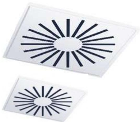
Диффузор DLRV – это корпус с патрубком с закрепленной к нему квадратной лицевой панелью. На панели радиально расположенные прорезы и встроенные дефлекторы предназначены для того, чтобы изменить направление движения воздушного потока. Конструктивно в диффузоре DLRV предусмотрено 2 рабочих варианта положения панели – использование по периметру воздуховыпускной щели, имеющей высоту 12 мм и без нее.
