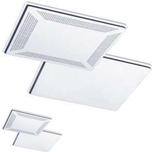
Устройство серии 1DLRA, 2DLRA – это корпус с патрубком и с закрепленной к нему квадратной перфорированной (1DLRA) или сплошной (2DLRA) лицевой панелью. В диффузорах DLRA заложено изменение высоты воздуховыпускной щели между корпусом изделия и панелью, она может быть 20 мм и 35 мм.
