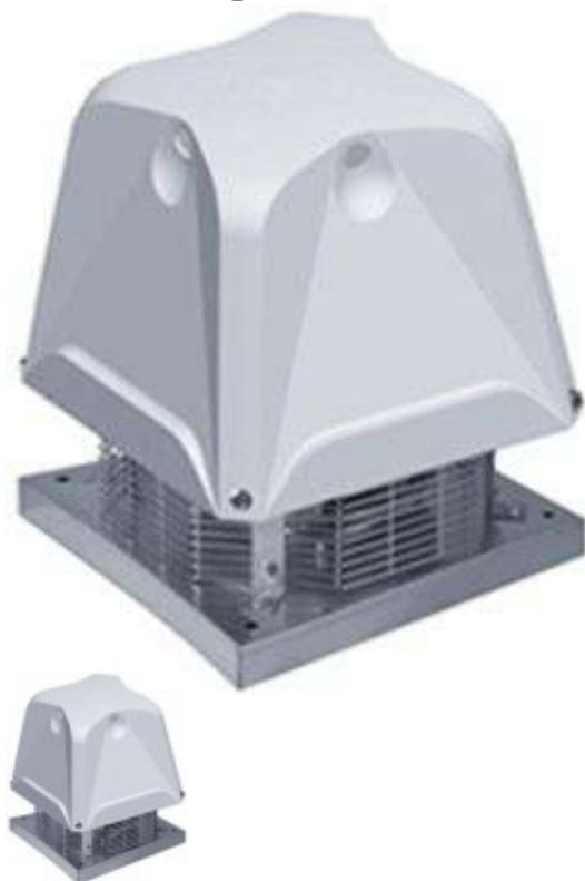
Вентиляторы вытяжного типа серии ТХР служат для удаления воздушной массы непосредственно из помещения или по воздуховодам, устанавливаются на крыше здания. Устройства такой модели оборудованы двигателем асинхронного типа с ротором короткозамкнутого вида и подшипниками качения.
