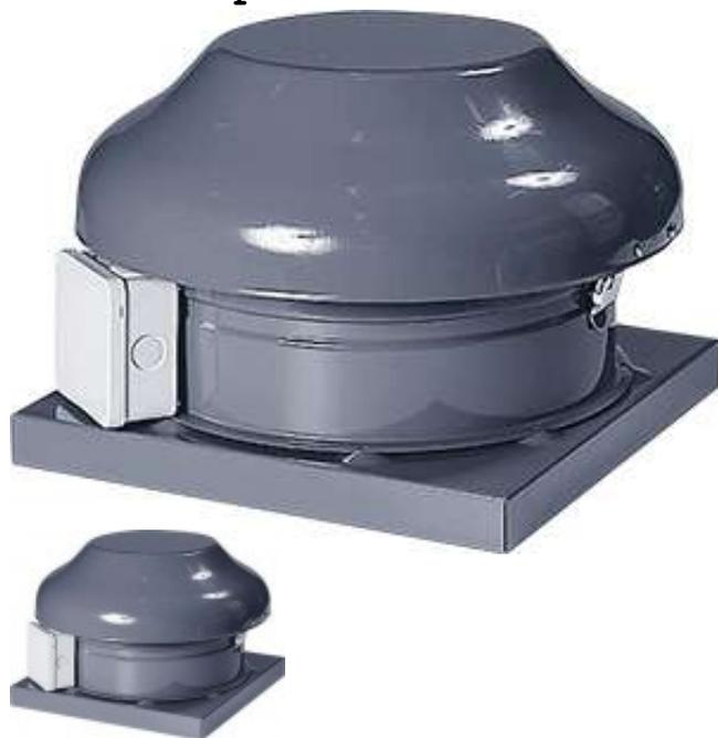
Вентиляторы серии TKS используются как вытяжные и устанавливаются на крышах зданий. Такое устройство укомплектовано двигателем асинхронного типа с ротором внешнего вида. Рабочее колесо такого вентилятора имеет лопасти, загнутые назад. Для лучшего сервисного обслуживания и профилактического ремонта двигатель вместе с рабочим колесом находятся на откидывающейся пластине.
