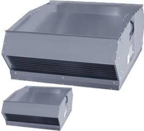
Вентиляторы серии ТКН от компании Ostberg относятся к крышным устройствам вытяжного типа. Такая модель имеет двигатель асинхронного вида и рабочее колесо, имеющее лопатки, загнутые назад. Находится двигатель и рабочее колесо на пластине откидного вида для лучшей профилактики и сервисного обслуживания вентилятора. Корпус вентилятора изготовлен из стали, покрытой защитным слоем металла, стойкого к воздействию коррозии.
