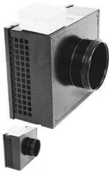
Настенные вентиляторы RS EC оснащены электронно-коммутируемым двигателем (ЕС-двигателем) с внешним ротором и рабочим колесом с загнутыми назад лопатками. Корпус вентиляторов изготавливается из оцинкованной стали. У вентиляторов RS EC корпус дополнительно окрашивается в черный цвет.
