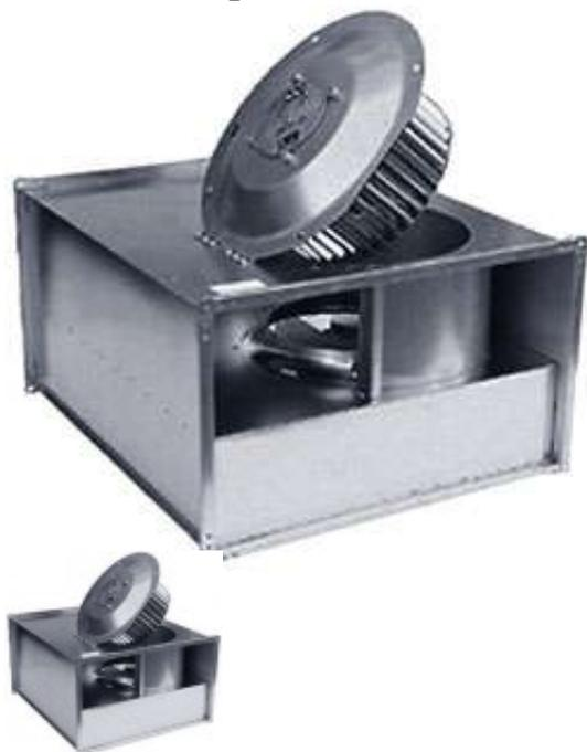
Вентиляторы серии RKX взрывозащищенного варианта канального типа укомплектованы двигателем асинхронного типа взрывозащищенного исполнения с ротором внешнего вида и рабочим колесом, имеющим лопасти, загнутые вперед. Рабочее колесо и двигатель для лучшего сервисного обслуживания и проведения ремонта находятся на пластине, откидывающейся в сторону.
