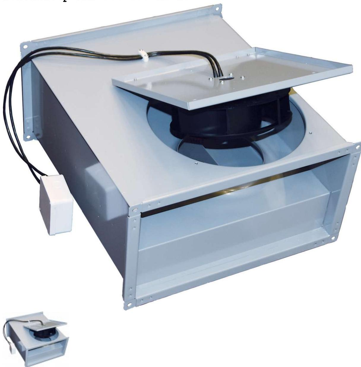
Канальные вентиляторы Ostberg серии RKB ЕС. Отличительная особенность – наличие электронно-коммутируемого двигателя, имеющего рабочее колесо с пластинами, слегка загнутыми назад и ротор внешнего типа. Последние элементы находятся на откидывающейся пластине, поэтому доступ к ним открыт. Корпус представлен прочной и долговечной сталью.
