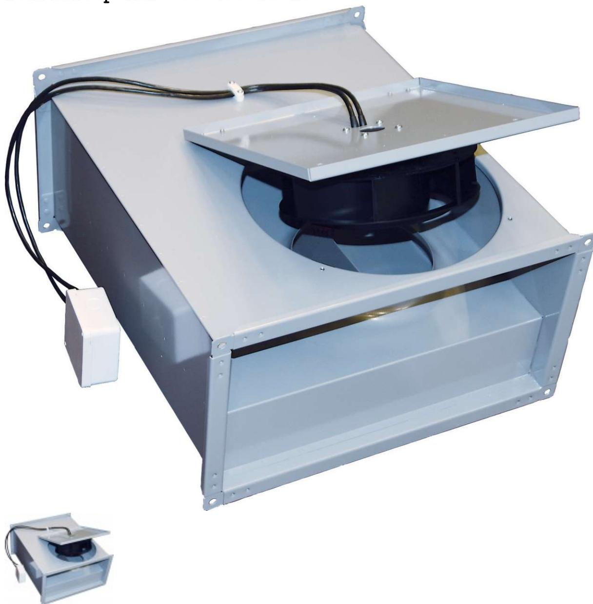
Канальные вентиляторы Ostberg серии RKB ЕС. Отличительная особенность – наличие электронно-коммутлируемого двигателя, имеющего рабочее колесо с пластинами, слегка загнутыми назад и ротор внешнего типа. Последние элементы находятся на откидывающейся пластине, поэтому доступ к ним открыт. Корпус представлен прочной и долговечной сталью.
