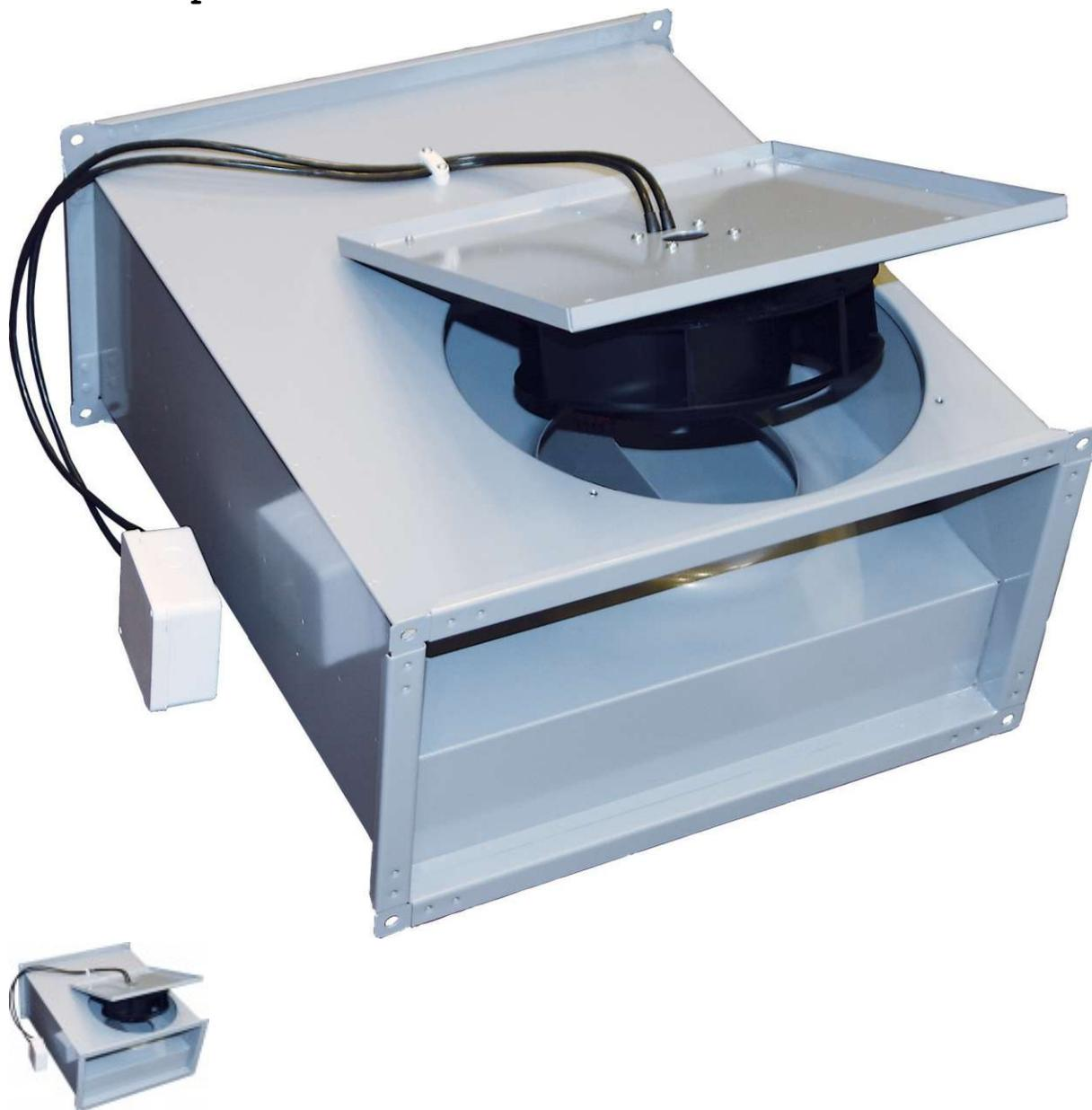
Канальные вентиляторы Ostberg серии RKB EC. Отличительная особенность – наличие электронно-коммутлируемого двигателя, имеющего рабочее колесо с пластинами, слегка загнутыми назад и ротор внешнего типа. Последние элементы находятся на откидывающейся пластине, поэтому доступ к ним открыт. Корпус представлен прочной и долговечной сталью.
