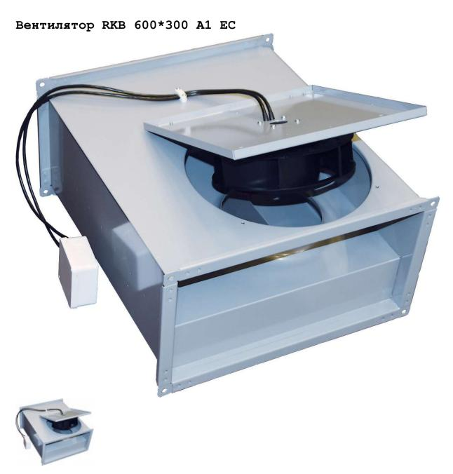
Канальные вентиляторы Ostberg серии RKB EC. Отличительная особенность - наличие электронно-коммутируемого двигателя, имеющего рабочее колесо с пластинами, слегка загнутыми назад и ротор внешнего типа. Последние элементы находятся на откидывающейся пластине, поэтому доступ к ним открыт. Корпус представлен прочной и долговечной сталью.
