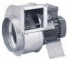
Центробежные взрывозащищенные вентиляторы типа RFTX оснащены вынесенным взрывозащищенным асинхронным двигателем с короткозамкнутым ротором и уплотненными подшипниками, что увеличивает срок их службы. Корпус вентилятора изготовлен из оцинкованной стали. Рабочее колесо вентилятора изготовлено из того же материала, что и корпус и проходит статическую и динамическую балансировку. Вентиляторы имеют загнутые вперед лопатки и выпускаются с односторонним всасыванием.
