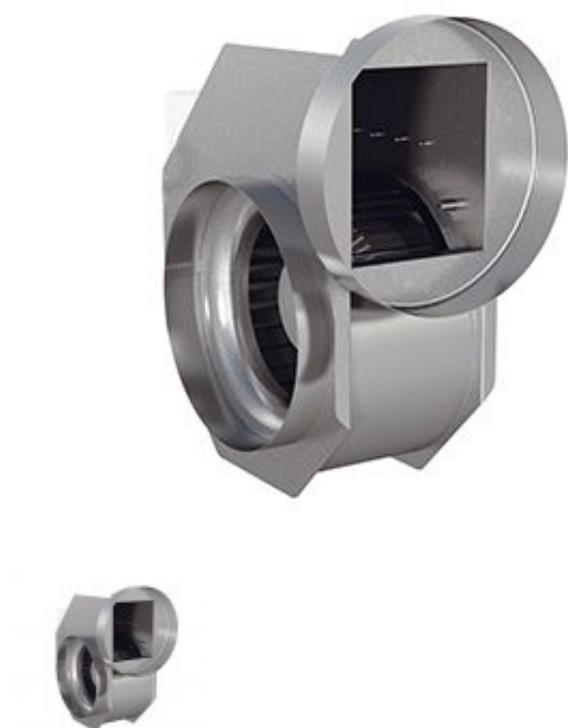
Центробежные вентиляторы серии RFT, рассчитанные на одностороннее всасывание, укомплектованы двигателем асинхронного типа с ротором внешнего вида. Рабочее колесо устройства имеет лопатки, загнутые вперед. Для удобства сервисного обслуживания колесо и двигатель находятся на откидной пластине.
