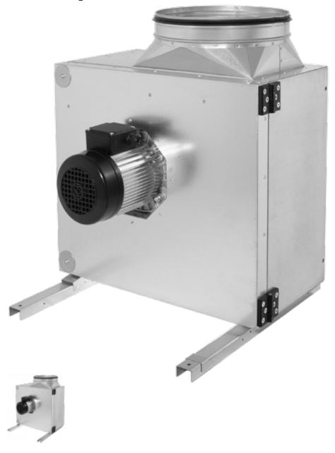
В вентиляторах использованы надежные однофазные электродвигатели переменного тока, управляемые по напряжению. На корпусе имеется специальная форма для сбора жира и патрубок для спуска, а также встроен термоконтакт, обеспечивающий автоматический перезапуск. Обслуживания не требует, шарикоподшипники служат долго.
