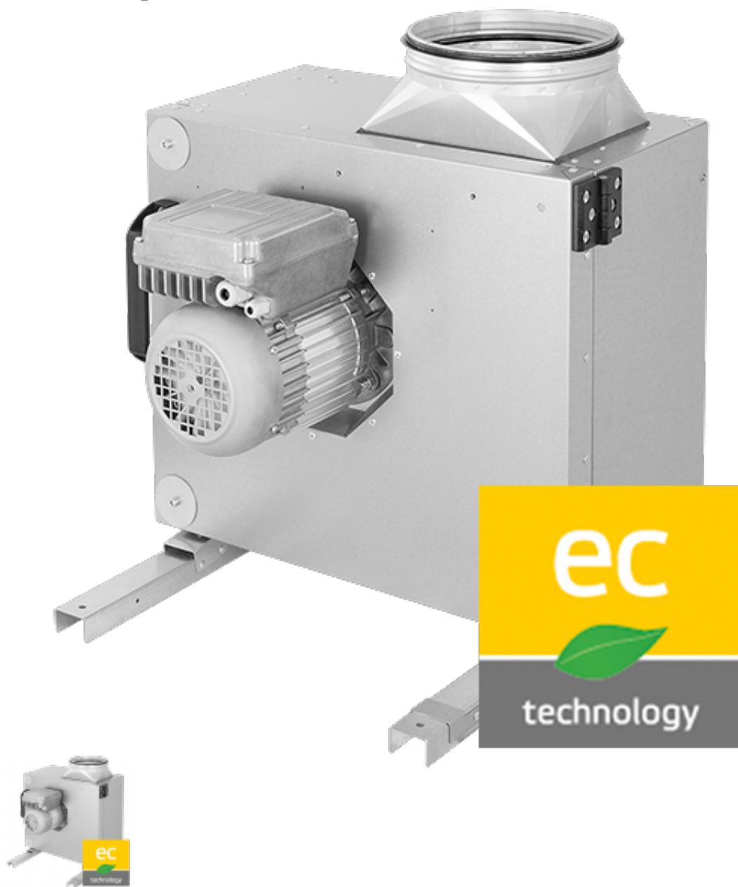
В вентиляторах использованы надежные однофазные электродвигатели переменного тока, управляемые по напряжению. На корпусе имеется специальная форма для сбора жира и патрубков для спуска, а также встроен термоконттакт, обеспечивающий автоматический перезапуск. Обслуживания не требует, шарикоподшипники служат долго.
