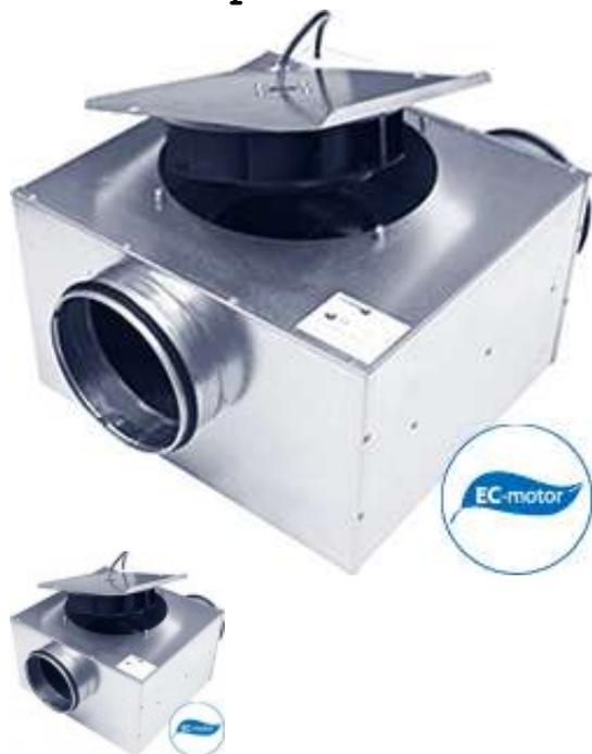
Низкопрофильные каналные вентиляторы LPKB Silent. Данные устройства обладают асинхронным мотором с наружным ротором и рабочим валом с направленными назад лопатками, которые размещаются на откидывающейся пластине. Оболочка вентиляторов производится из гальванизированной стали. Они разработаны для стыка с круглыми воздуховодами.
