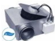
Данные устройства обладают двигателем с электронной коммутацией, наружным ротором и рабочим валом с направленными назад лопатками. Двигатель и колесо находятся на откидывающейся пластине. Оболочка приборов производится из гальванизированной стали. Аппараты данной серии разработаны для стыка с круглыми каналами.
