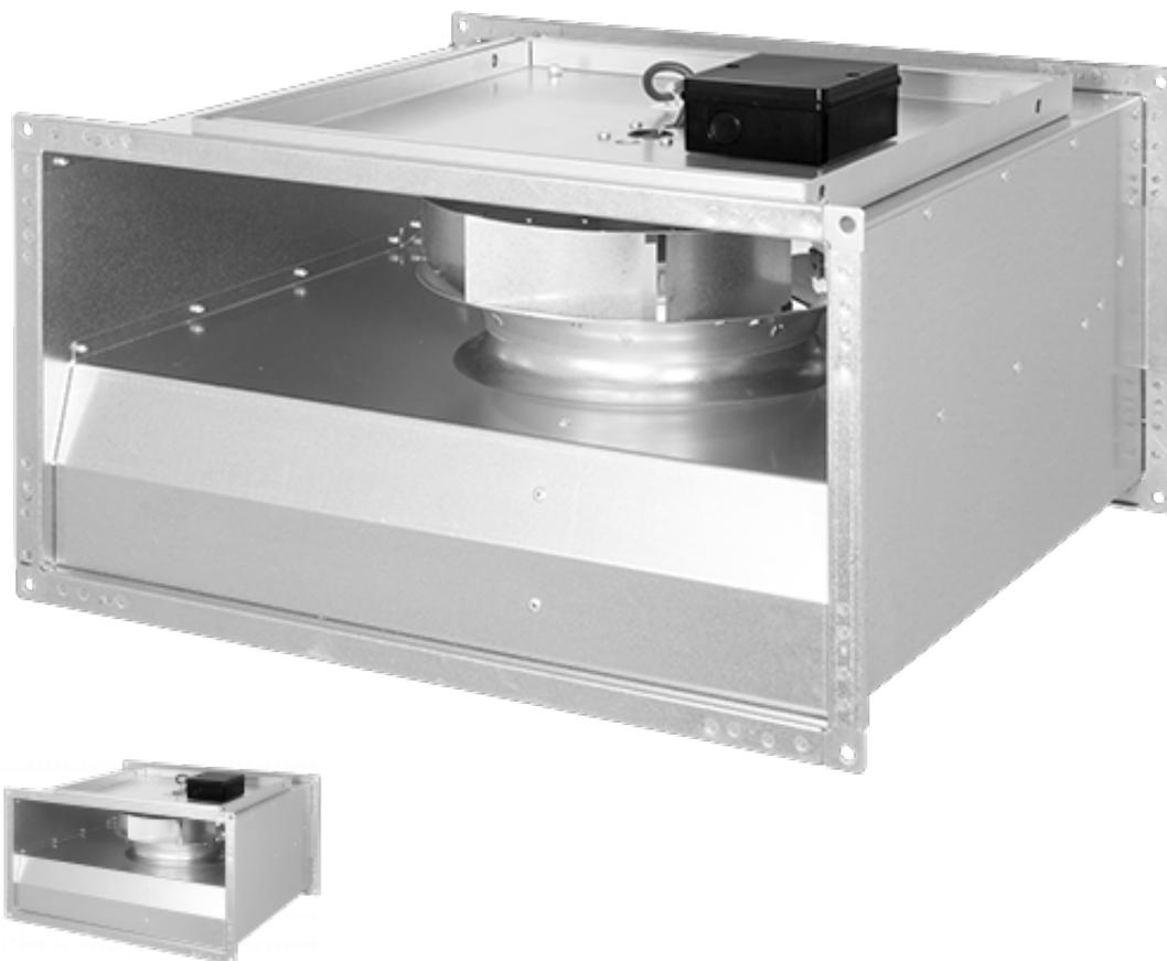
Предназначен для монтажа в системах приточной и вытяжной вентиляции. Центробежный вентилятор с загнутыми вперед лопатками. Встроенный термодатчик с автоматическим перезапуском. Корпус вентилятора изготовлен из оцинкованной листовой стали.
