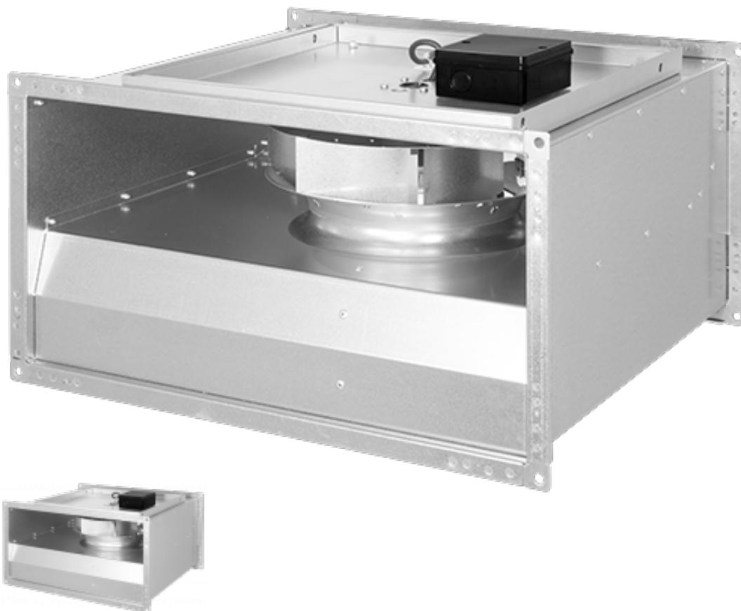
Предназначен для монтажа в системах приточной и вытяжной вентиляции. Центробежный вентилятор с загнутыми вперед лопатками. Встроенный термоконтакт с автоматическим перезапуском. Корпус вентилятора изготовлен из оцинкованной листовой стали.
