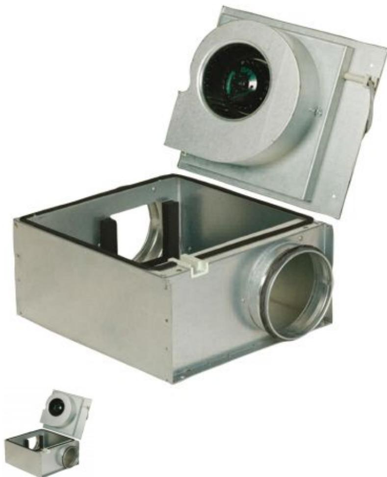
Вентилятор серии KVK Slim – это радиальный вентилятор, имеющий двухстороннее всасывание и обеспечен рабочими поплавками, загнутыми вперед. Приводом устройства является электродвигатель с ротором внешнего вида, не нуждающийся в дополнительном обслуживании в процессе работы. Скорость вращения регулируется.
