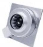
Настенные вентиляторы KVFU ЕС оснащены электронно-коммутируемым двигателем (ЕС-двигателем) с внешним ротором и рабочим колесом с загнутыми назад лопатками. Корпус вентиляторов изготавливается из оцинкованной стали.
