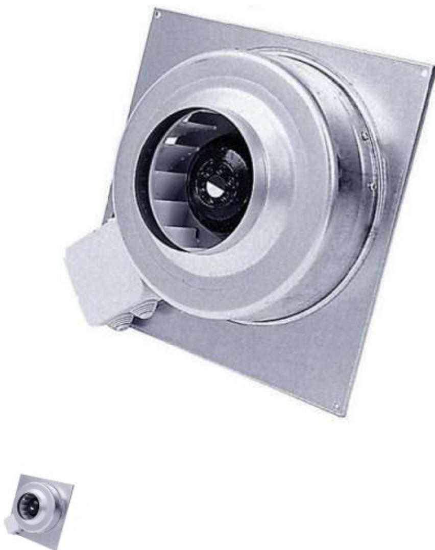
Настенные вентиляторы KVFU ЕС оснащены электронно-коммутируемым двигателем (ЕС-двигателем) с внешним ротором и рабочим колесом с загнутыми назад лопатками. Корпус вентиляторов изготавливается из оцинкованной стали.
