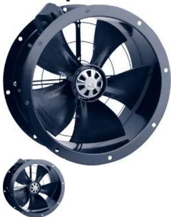
Вентиляторы серии ECR осевого типа используются для монтажа в каналах и воздуховодах, имеющих круглое сечение. Установки данной серии укомплектованы высокоэффективным двигателем асинхронного вида и крыльчаткой. Корпус, в котором находится вентилятор, выполнен из стали и покрашен в черный цвет. Уровень защиты двигателя от возможных перегрузок отвечает классу IP 55. Монтируются вентиляторы ECR в любом удобном положении.
