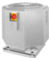
Крышный вентилятор серии DVNI оснащены изоляцией из слоя минеральной ваты толщиной 40 мм. Минеральные волокна зафиксированы с помощью износостойкой некрученой стеклонити. Перфорированная панель эффективно обеспечивает дополнительную механическую защиту.
