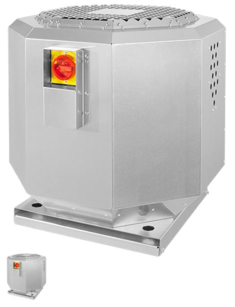
Крышный вентилятор серии DVNI оснащены изоляцией из слоя минеральной ваты толщиной 40 мм. Минеральные волокна зафиксированы с помощью износостойкой некрученой стеклонити. Перфорированная панель эффективно обеспечивает дополнительную механическую защиту. Вейяйне:вПорасбае рейтинтавару
