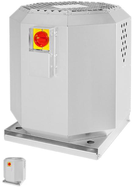
Наружный корпус изготовлен из сплава AIMg3, стойкого к воздействию морской воды. Двигатель находится вне воздушного потока, управляемый по напряжению. Вентилятор откидывается для проведения визуального контроля. С аварийным выключателем. Вентилятор может применяться для удаления воздуха с температурой до  $120\,$  °C из промышленных кухонь. Встроенный лоток для сбора жира позволяет избежать осаждения на поверхности крыши частиц жира, содержащихся в удаляемом воздухе.
