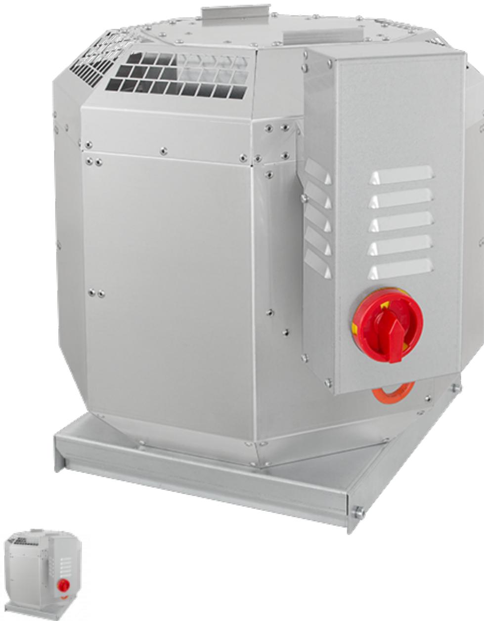
Корпус изготовлен из высококачественного алюминия. Ventilator серии DVN имеет низкое энергопотребление. Ventilator откидывается для проведения визуального контроля. С аварийным выключателем. Ventilator может применяться для удаления воздуха с температурой до 120 °C из промышленных кухонь. Встроенный лоток для сбора жира позволяет избежать осаждения на поверхности крыши частиц жира, содержащихся в удаляемом воздухе.
