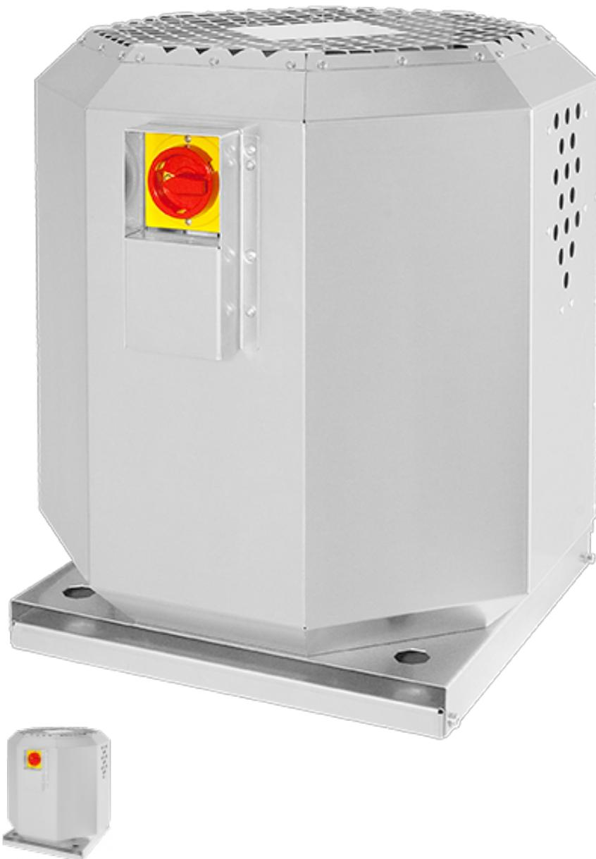
Наружный корпус изготовлен из сплава А1Мg3, стойкого к воздействию морской воды. Двигатель находится вне воздушного потока, управляемый по напряжению. Вентилятор откидывается для проведения визуального контроля. С аварийным выключателем. Вентилятор может применяться для удаления воздуха с температурой до 120 °С из промышленных кухонь. Встроенный поток для сбора жира позволяет избежать осаждения на поверхности крыши частиц жира, содержащихся в удаляемом воздухе.
