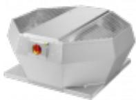
Центробежный вентилятор с загнутыми назад лопатками ЕС-электродвигатель Встроенные электронные устройства Внутренний электронный контроль температуры Корпус из сплава алюминия AlMg3 Встроенный выключатель. С устройством поддержания постоянного давления
