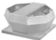
Крышный вентилятор DVA управляемый по напряжению. Встроенный термодатчик. Внешние части корпуса из металла. Высококачественный, прочный корпус. Вертикальный выход воздуха сокращает загрязнение крыши. Кроме того, уровень испускаемого шума становится значительно ниже, чем при горизонтальном выходе воздуха из крышных вентиляторов. Используемые вентиляторы с загнутыми назад лопатками защищены от загрязнения и имеют высокий КПД.
