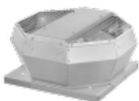
Крышный вентилятор DVA управляемый по напряжению. Встроенный термодатчик. Внешние части корпуса из металла. Высококачественный, прочный корпус. Вертикальный выход воздуха сокращает загрязнение крыши. Кроме того, уровень испускаемого шума становится значительно ниже, чем при горизонтальном выходе воздуха из крышных вентиляторов. Используемые вентиляторы с загнутыми назад лопатками защищены от загрязнения и имеют высокий КПД.
