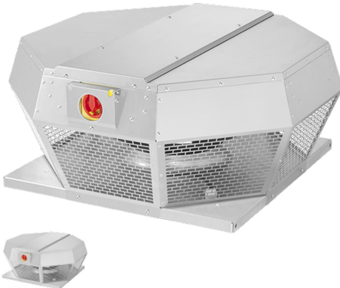
Крышный вентилятор DHA с регулятором скорости с завода оснащен ремонтным выключателем. Защитная решетка на выходе предохраняет от засорения, вызванного листвой и птицами. Высококачественный, металлический корпус. Используемые вентиляторы с загнутыми назад лопатками защищены от загрязнения и имеют высокий КПД.
