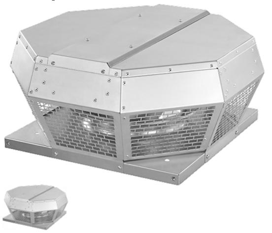
Крышный вентилятор DHA C регулятором скорости. Встроенный термовыключатель. Защитная решетка на выходе предохраняет от засорения, вызванного листвой и птицами. Высококачественный, металлический корпус. Используемые вентиляторы с загнутыми назад лопатками защищены от загрязнения и имеют высокий КПД.
