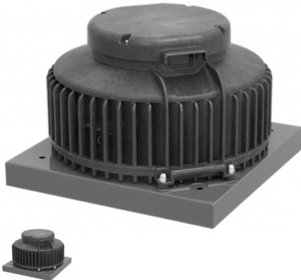
Крышный вентилятор DHA С регулятором скорости. Встроенный термовыключатель. Для проведения технического обслуживания вентилятор можно отключить от напряжения прямо на корпусе. При необходимости визуального контроля вентилятор можно откинуть. Используемые вентиляторы с загнутыми назад лопатками защищены от загрязнения и имеют высокий КПД.
