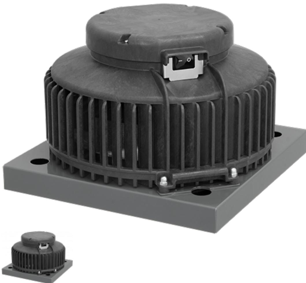
Крышный вентилятор DHA С регулятором скорости. Встроенный термовыключатель. Для проведения технического обслуживания вентилятор можно отключить от напряжения прямо на корпусе. При необходимости визуального контроля вентилятор можно откинуть. Используемые вентиляторы с загнутыми назад лопатками защищены от загрязнения и имеют высокий КПД.
