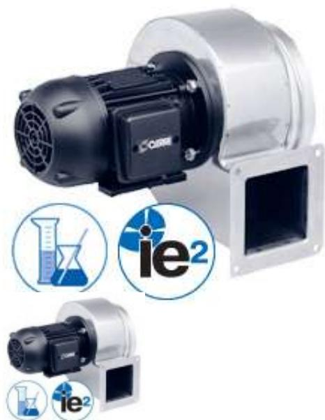
Центробежные вентиляторы с односторонним всасыванием САА специально разработаны для удаления воздуха, содержащего пары химических реагентов и коррозионно-активных веществ. Вентиляторы САА оснащены вынесенным энергоэффективным асинхронным двигателем и рабочим колесом с загнутыми вперед лопатками.
