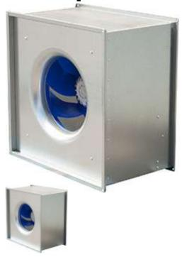
Канальные вентиляторы BFS EC оснащены электронно-коммутируемым двигателем (ЕС-двигателем) с внешним ротором и рабочим колесом с загнутыми назад лопатками. Корпус вентиляторов изготавливается из оцинкованной стали.Вентиляторы BFS EC предназначены для соединения с воздуховодами квадратного сечения. Степень защиты электродвигателя и клеммной коробки — IP 54 Вейжите:вПорасбио рейтингавару
