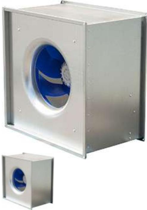
Канальные вентиляторы BFS EC оснащены электронно-коммутируемым двигателем (ЕС-двигателем) с внешним ротором и рабочим колесом с загнутыми назад лопатками. Корпус вентиляторов изготавливается из оцинкованной стали. Вентиляторы BFS EC предназначены для соединения с воздуховодами квадратного сечения. Степень защиты электродвигателя и клеммной коробки – IP 54
