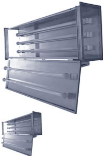
Фильтры бактерицидной обработки воздуха ФБО предназначены для бактерицидной обработки приточного или рециркуляционного воздуха с помощью ультрафиолетового излучения. Фильтры применяются для проведения санитарно-противоэпидемических (профилактических) мероприятий, способствующих соблюдению санитарных норм и правил по устройству и содержанию помещений, направленных на снижение количества микроорганизмов и профилактику инфекционных заболеваний.
